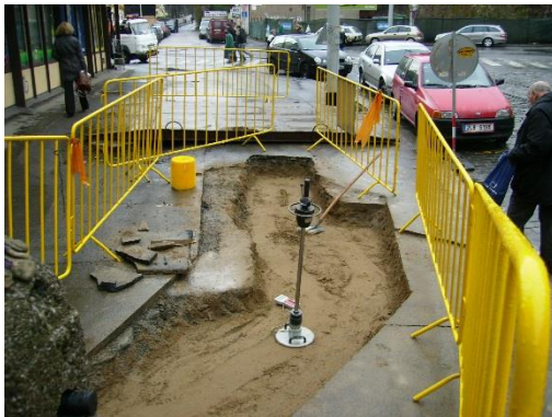
◀ Rázová zatěžovací zkouška lehkou dynamickou deskou
