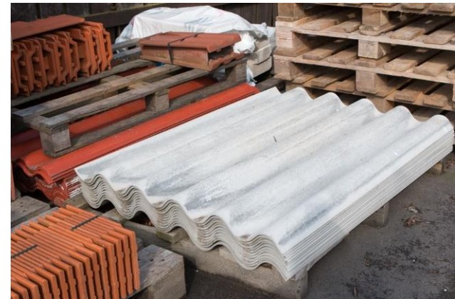
Vláknocementová skládaná střešní krytina – velkoplošné vlnité desky ▲
