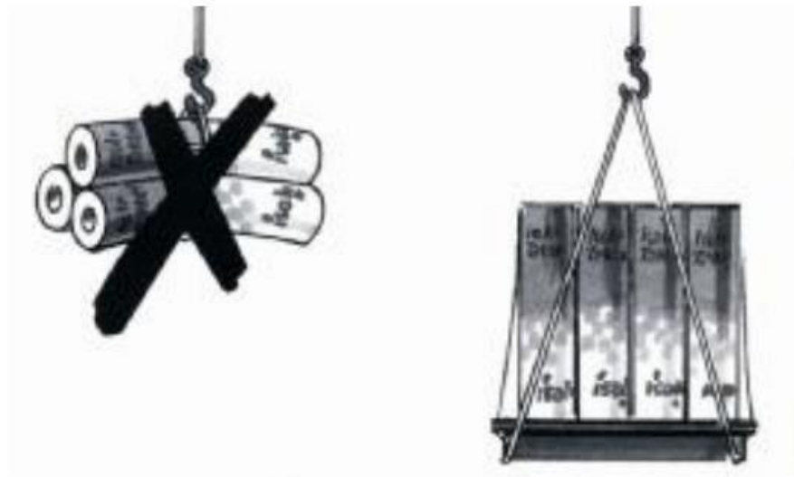
▲ Doprava asfaltových izolačních pásů
